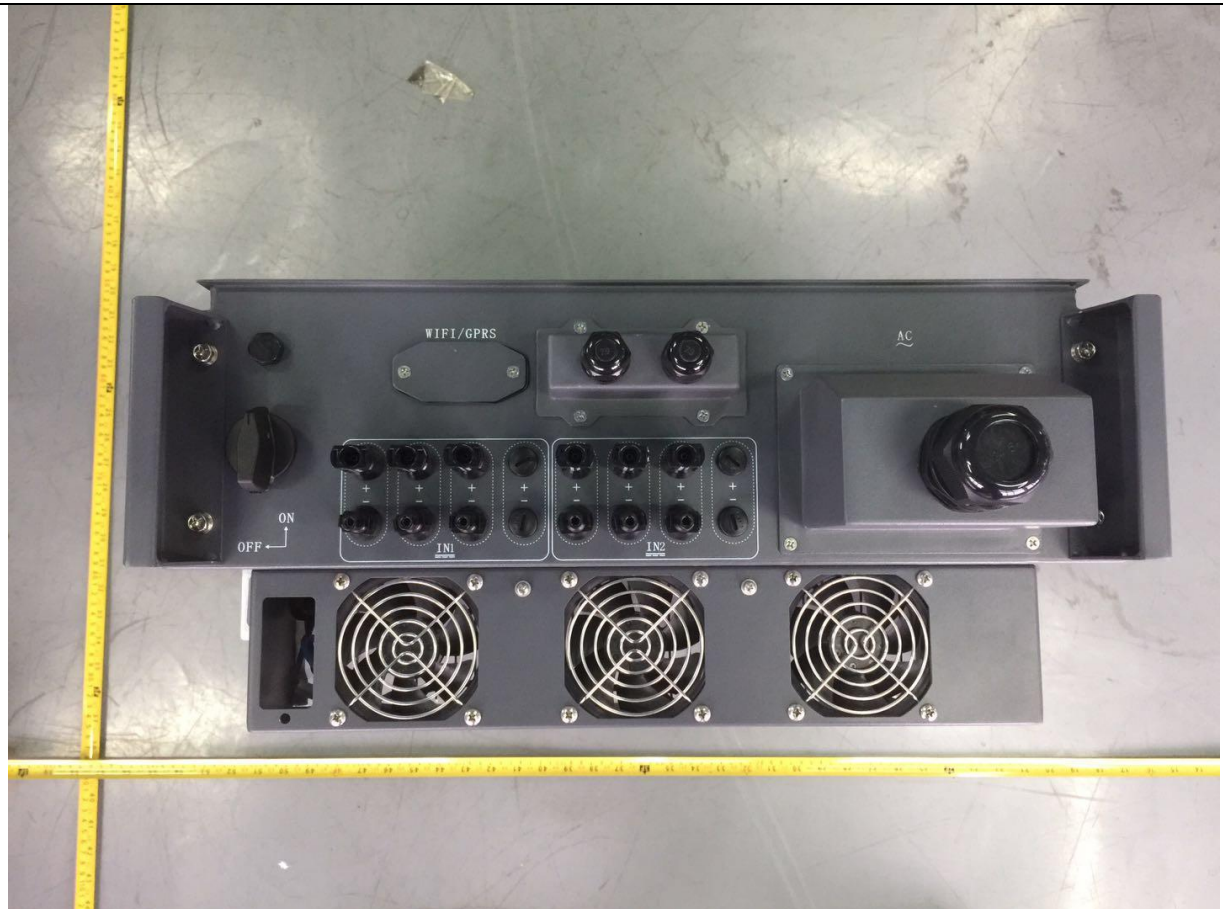
Photo31 ( Terminal interface ) SOFAR 30000TL 、 SOFAR 33000TL
